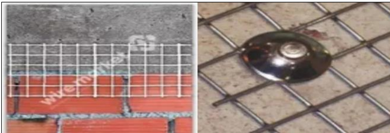
Figura 3– Posicionamento da tela e modo de fixação (Interface alvenaria/estrutura)
